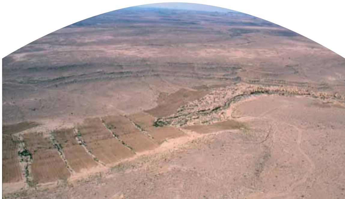
איור 15 (למטה): נחל צנע – סכר במרכז המערכת, נבנה על גבי הטרסה הטבעית (מתחת לקו השחור). מאחוריו הצטברות אנתרופוגנית של אדמת לס בעובי כ-2 מ'.
